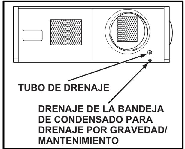
1. Utilice la conexión macho de 1/2 pulgada (13 mm) suministrada en la unidad para el drenaje del condensado del serpentín del evaporador. La línea de drenaje se debe ubicar en forma tal que no esté expuesta a temperaturas de congelación. El drenaje debe tener la medida total de la conexión de drenaje. (Conecte la manguera de drenaje al drenaje de condensación o al armario del conserje).
